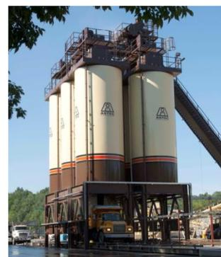
Les silos sont positionnés sur deux lignes de 5 silos chacune (sur châssis métalliques lestés et ponts bascules).
